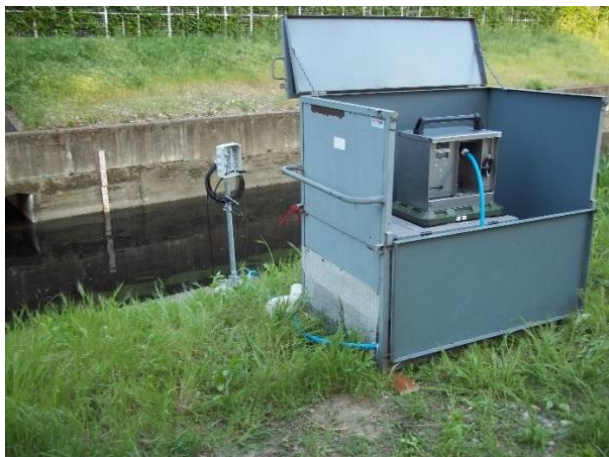
Figura 53 – Autocampionatore installato sul T. Seveso
